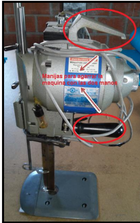
Foto 25: Máquina de corte tipo vertical con sus 2 empuñaduras – Sector Corte
