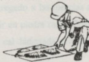
5. Utilice dos partes diagonales para las pruebas.
