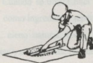
3. Introduzca una vara por debajo de la tela y levante los extremos para dividir la muestra en dos partes iguales.
