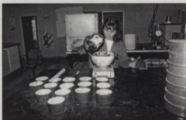
**ADICIÓN DE ASFALTO AL AGREGADO**
