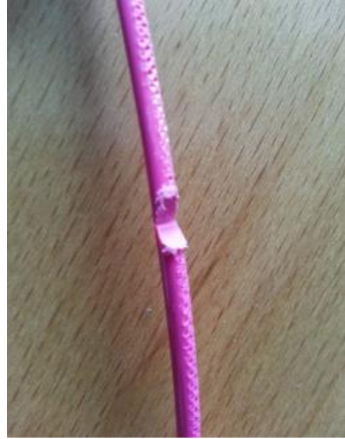
Ilustración 5: Filamento desgastado por excesiva presión del tornillo acanalado.
