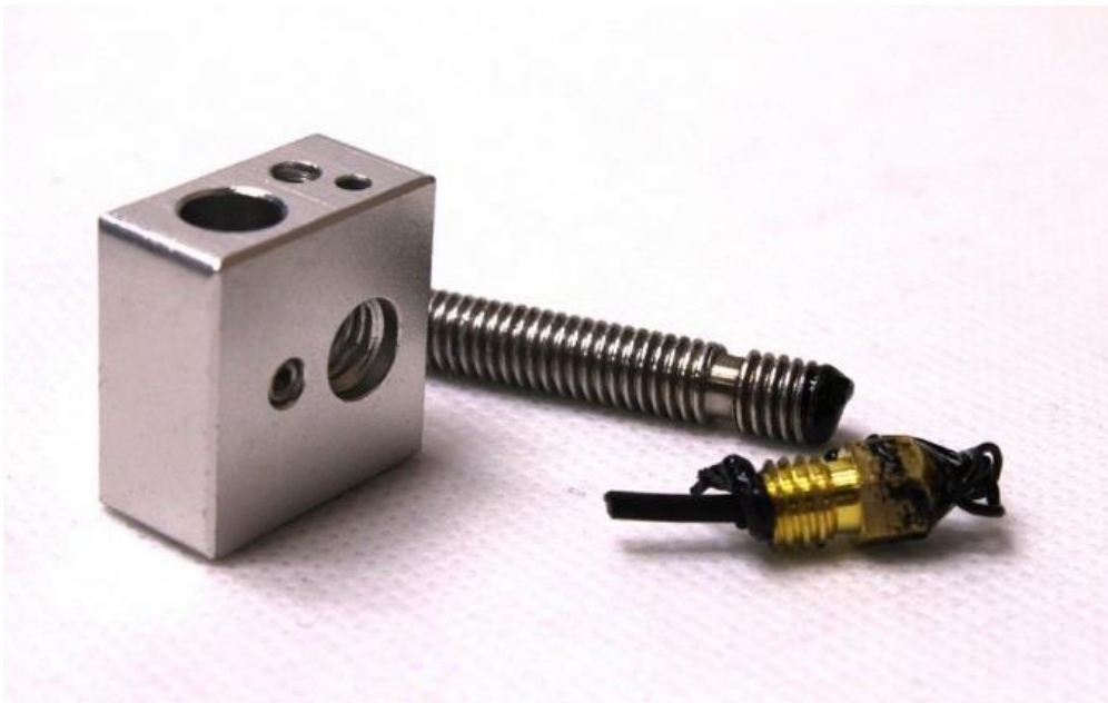
Ilustración 4: Ejemplo de Extrusor tapado.
