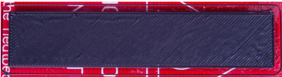
Ilustración 5: Boquilla en posición correcta. Se observa un flujo constante de filamento.
