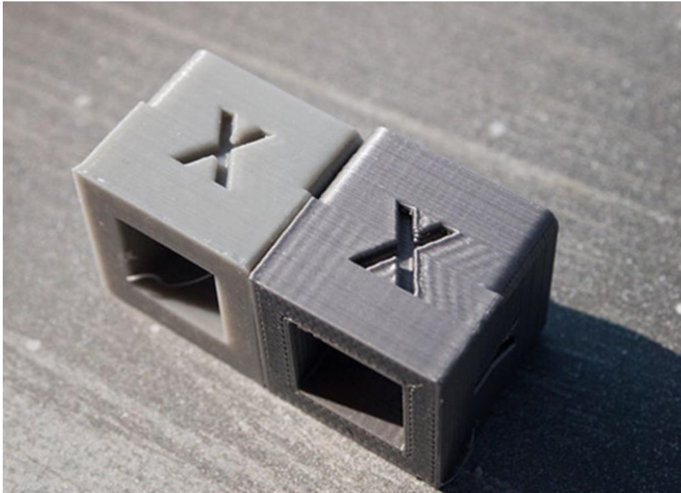
Ilustración 28: Efecto de las vibraciones provocadas por la inercia en la calidad de impresión.
