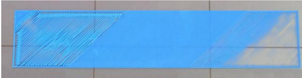
Ilustración 64: Primera capa a diferentes alturas, de más alto a más bajo. (Derecha a izquierda)
