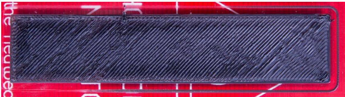
Ilustración 4: Boquilla muy cerca de la cama. Filamento se comprime contra el vidrio.
