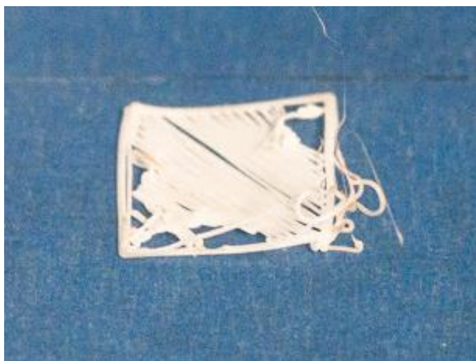
Ilustración 9: Pieza desprendida por una mala adhesión a la cama.
