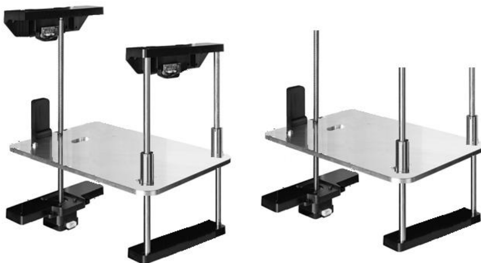
Ilustración 5: Sistema de transmisión eje Z. Tornillo de potencia.
