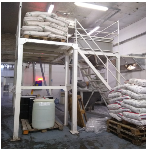
Figura 63: Molienda de azúcar cristal
