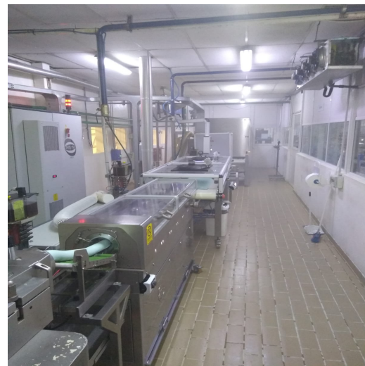
Figura 64: Etapa de rellenado, enfriado y corte de la masa
