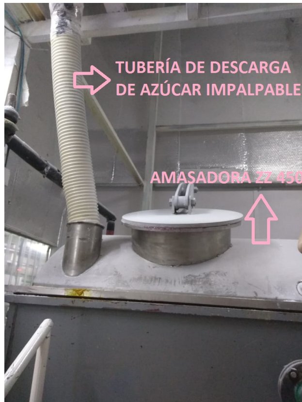
Figura 72: Tubería de descarga de azúcar impalpable a la amasadora ZZ 450
