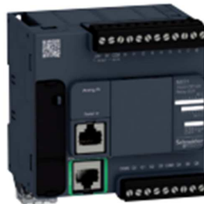
Imagen 96: PLC Marca Schneider Modelo Modicon M221 TM221CE16R .
