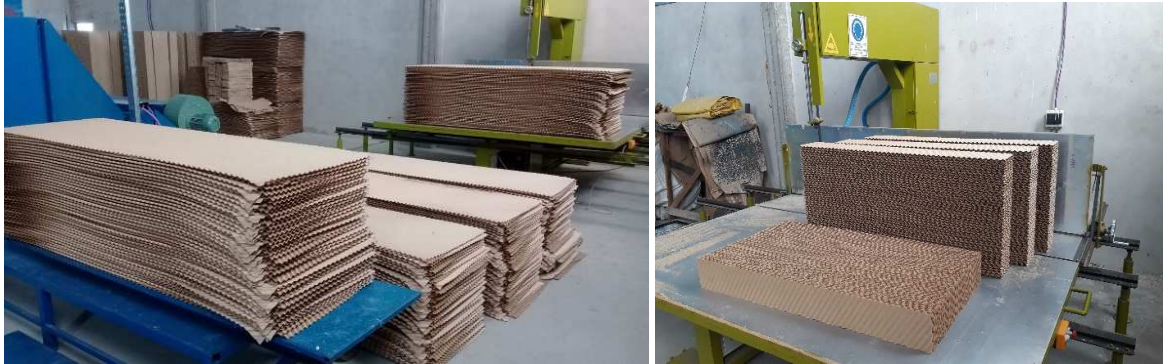
Imagen 11: Batches pegados y curados listos para ser aserrados (izquierda) y Paneles Evaporativos ya cortados (derecha).
