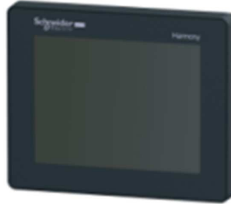
Imagen 97: Magelis STU 3,5" Color Touch 22 [mm] Modelo HMISTU655.
