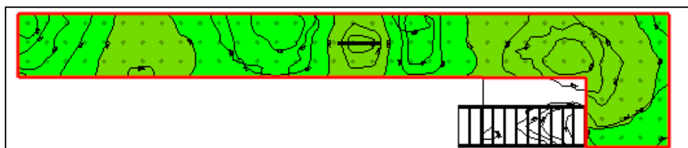
Figura 33.- Distribución de la iluminancia sobre la pasarela.
