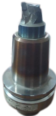
Figura 53: Portaherramientas Leitz HSK-F63 de 25[mm]
