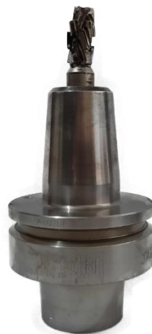
Figura 54: Portaherramientas Leitz HSK-F63 de 12[mm]
