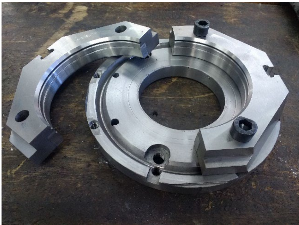
Fig. 10-44 Inserto de sujeción de piezas partidas para torneado [A-44]
