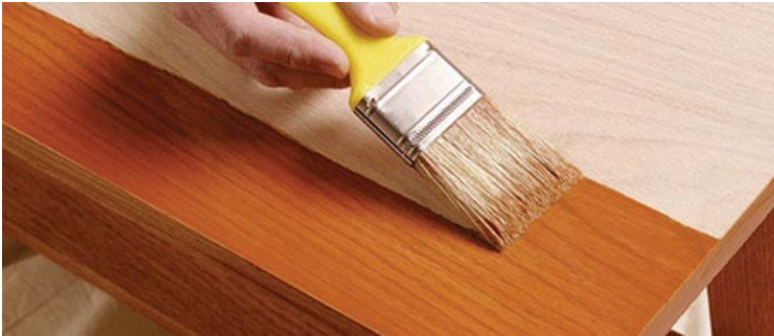
Fig. 3-50 Aplicación de barniz en superficie de madera. [E-50]
