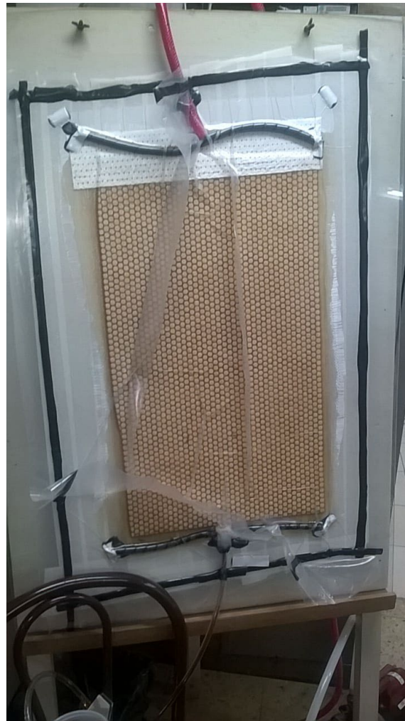
Fig. 10-48 Sellado en láminas. [L-48]
