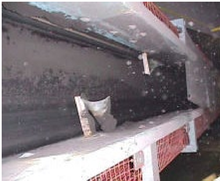
Fig. 7 Placas helicoidales en la parte lateral de la banda.
