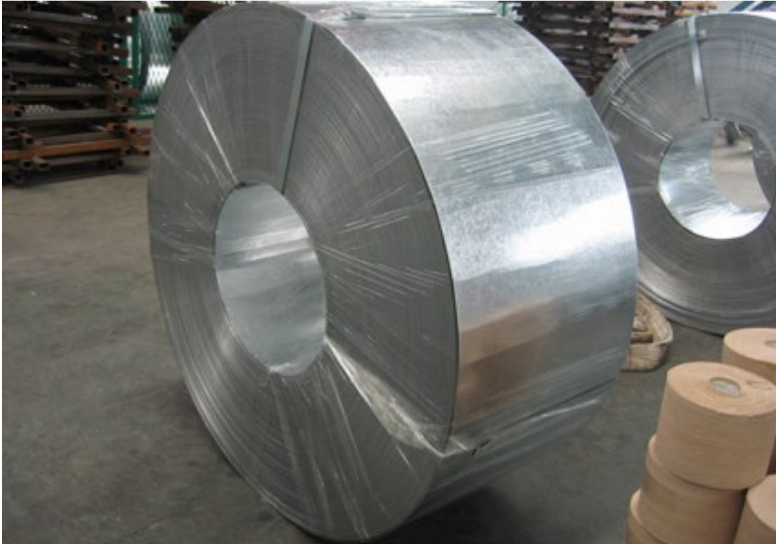
Fig. 5-50 Recubrimiento por galvanizado de zinc en faja de acero. [G-50]
