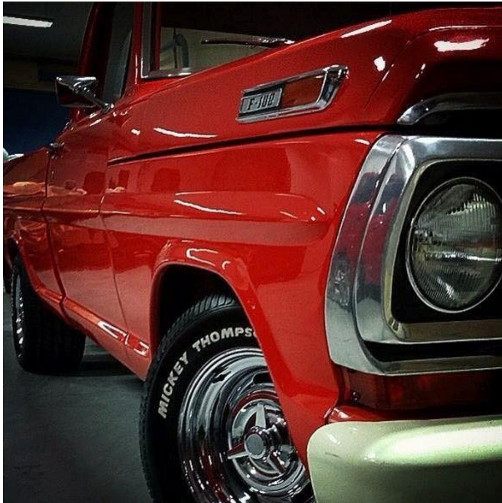
Fig. 13-45 Ejemplo de Pintura Automotriz Automotor (bicapa-acr lica-poliuret nica). [N -45]
