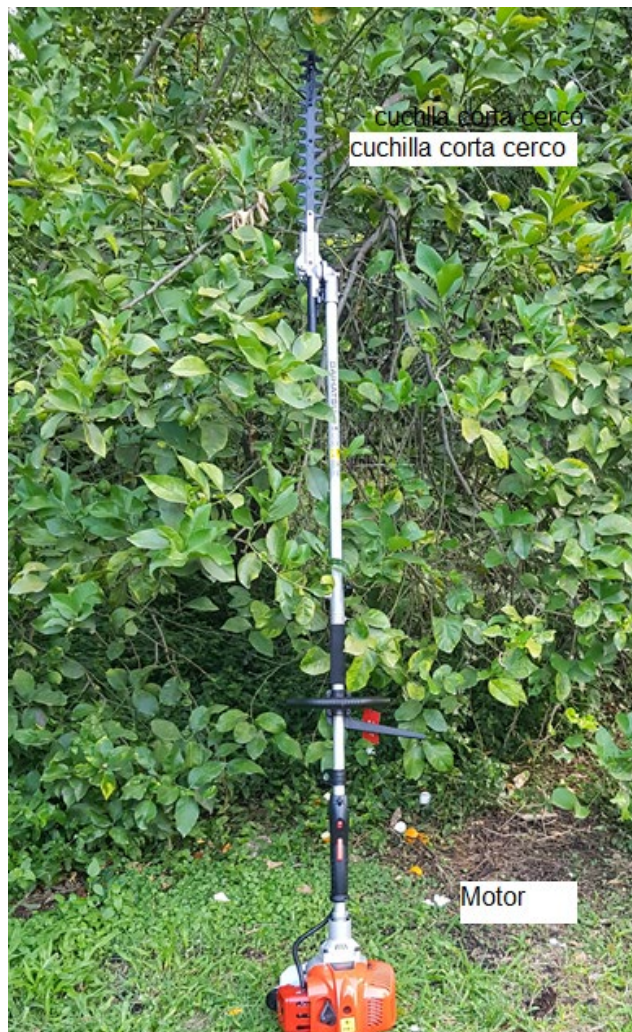
Fig. 10-45 Detalle de la cuchilla corta cerco inserta en la máquina. [K-45]
