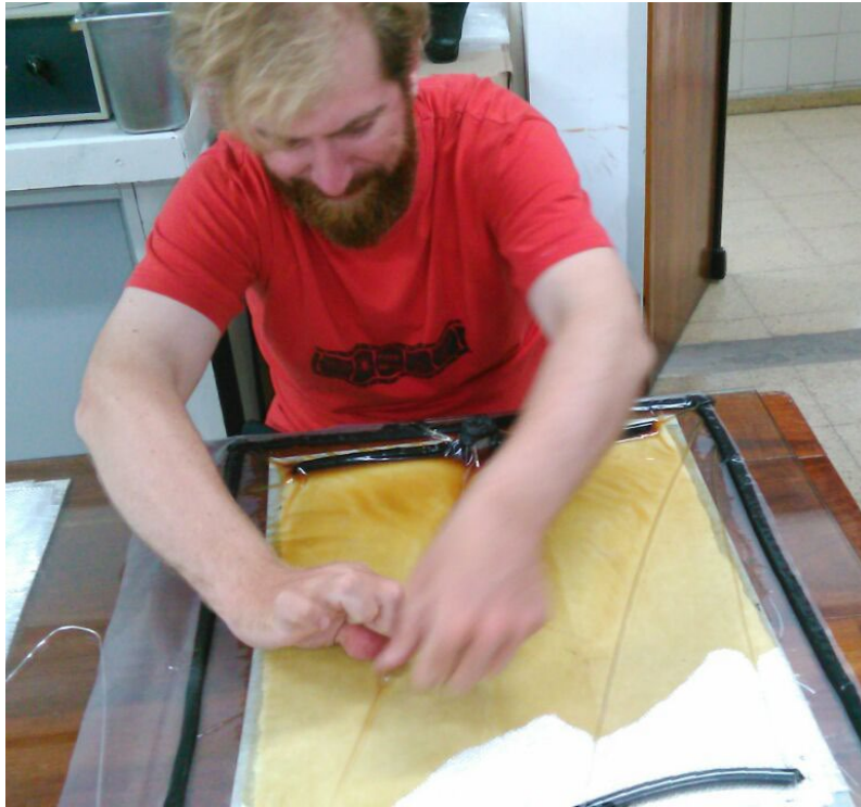
Fig. 8-48 Preparación del sistema con bolsa. [L-48]
