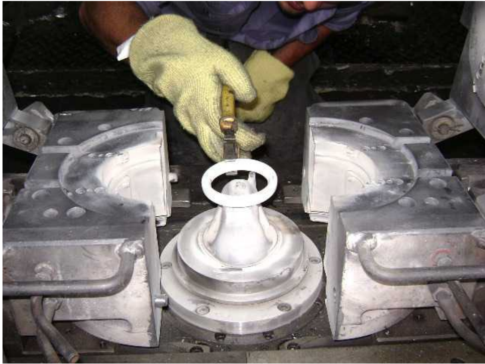
Fig. 12-44 Noyo antes de verter la colada. [K-44]
