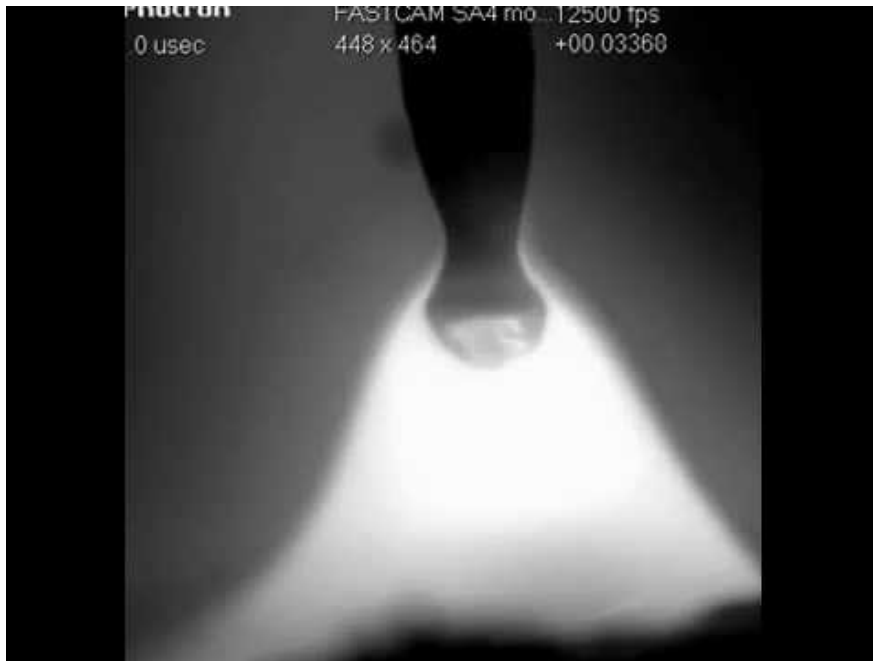
Fig. 4-41 Foto de filmación de soldadura por arco. [E-41]
