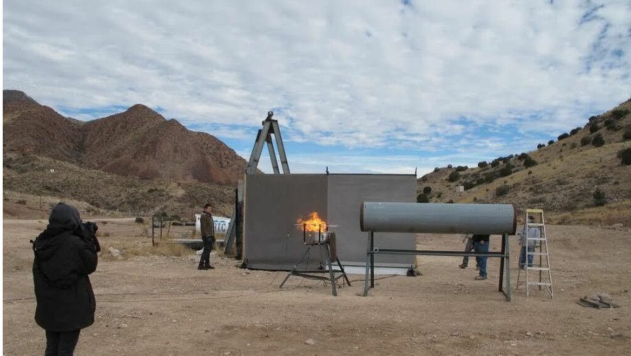
Fig. 9-46 Experimento del Dr. Graham Doig en Nuevo México para comprobar su sistema de extinción de incendios. El tubo de la foto permite producir una explosión que genera una onda de aire que empuja al fuego lejos de su fuente de combustible, dando como resultado la extinción de éste. [Ñ-46]
