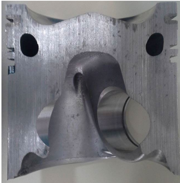
Fig. 14-44 Corte del pistón, producto final, con la galería correctamente fabricada. [K-44]
