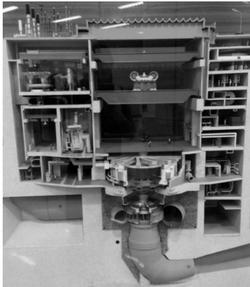
Fig. 7.32. Corte esquemático de sala de máquinas de central Itaipú.
