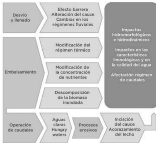
Fig. 7.34. Esquema simplificado de las principales afectaciones de las presas por cambios hidromorfológicos, hidrodinámicos y calidad del agua.<sup>70</sup>
