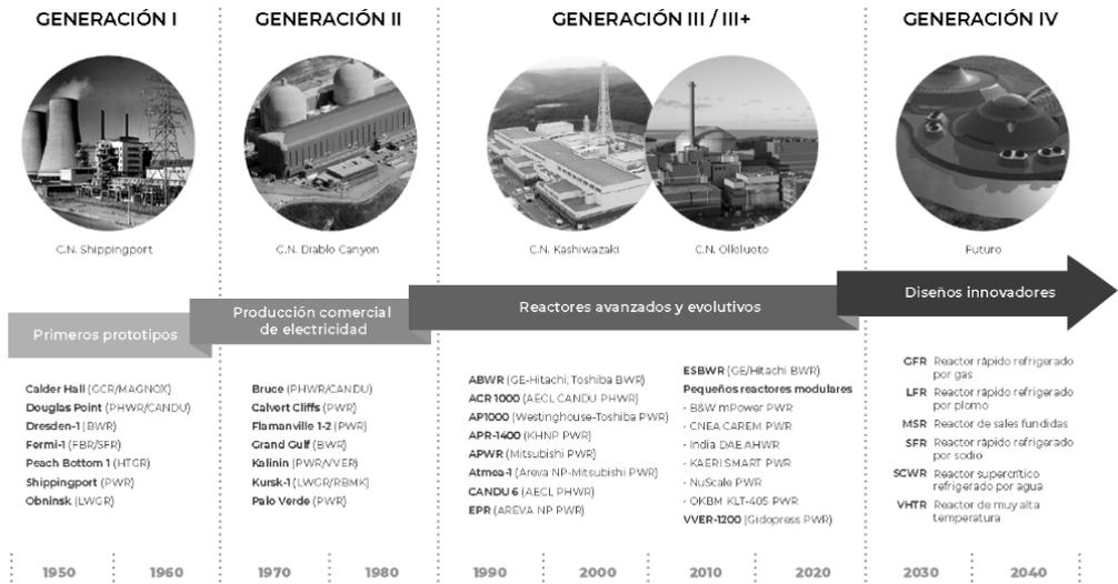
Fig. 8.25. Generaciones de reactores nucleares<sup>84</sup>.
