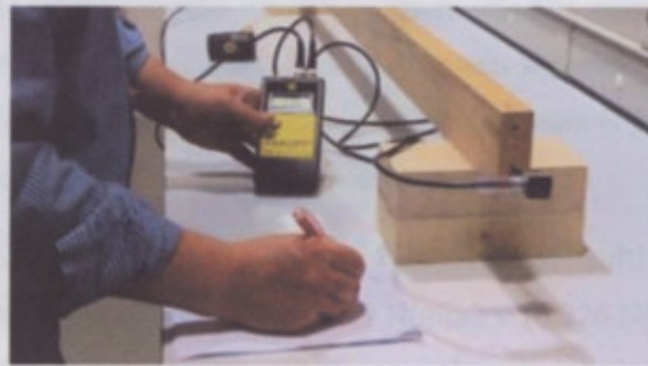
Figura 12 Velocidad de propalación de ondas ultrasónicas.
