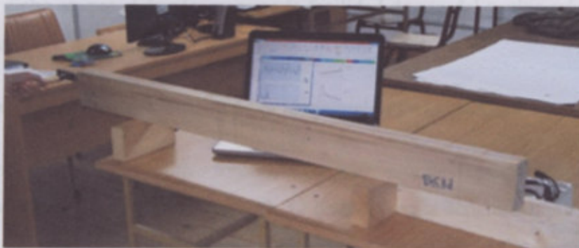
Figura 11 Frecuencia de resonancia de una vibración longitudinal.
