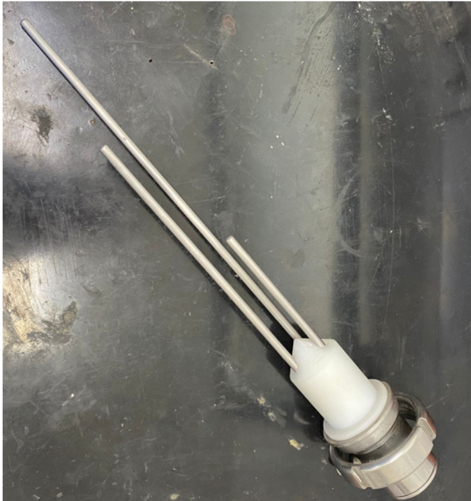
Fig. N° 3 Varillas para control de nivel.
