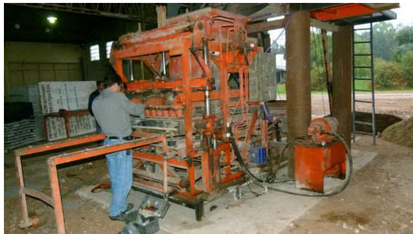
FIGURA 4.37 INSTALACIÓN BLOQUERA EN VILLA ELISA.
