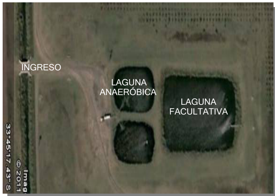
Disposición de lagunas para camiones atmosféricos
