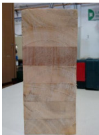
Figura 22: Corte de viga laminada.
