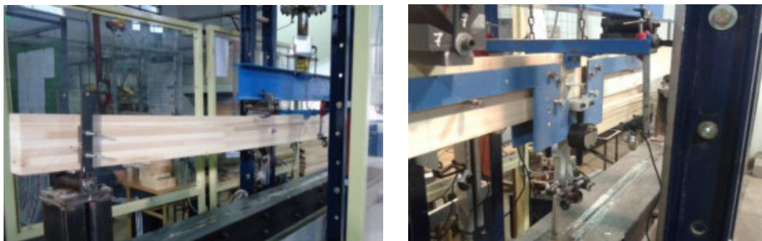
Figura 28: Ensayo de viga laminada a flexión.
