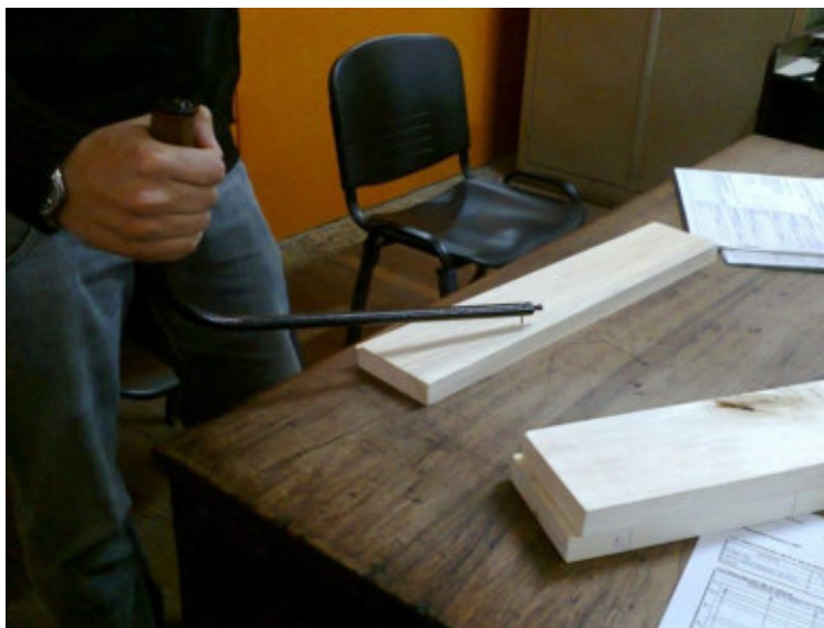
Figura 18: Trazador para determinar desviación de fibra.
