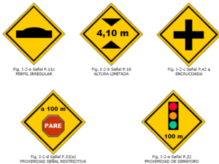
Figura 159 –Señales de Prevención.
