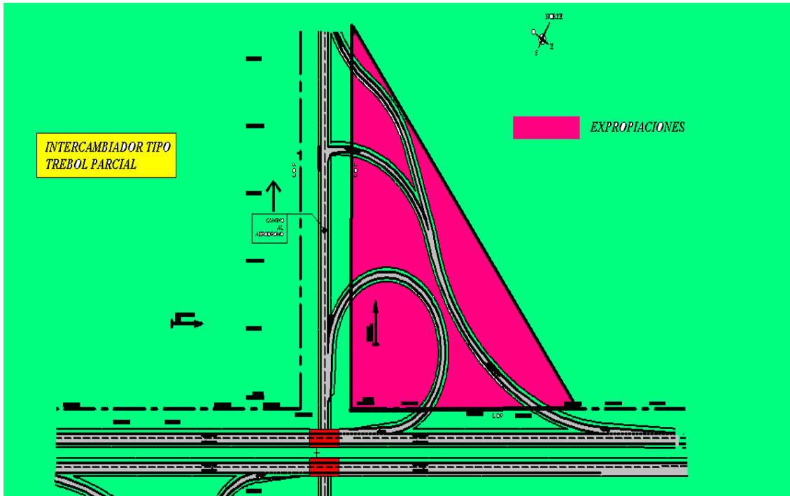
Figura 41-Diamante Tipo Trébol Parcial-Esquema de Expropiación.
