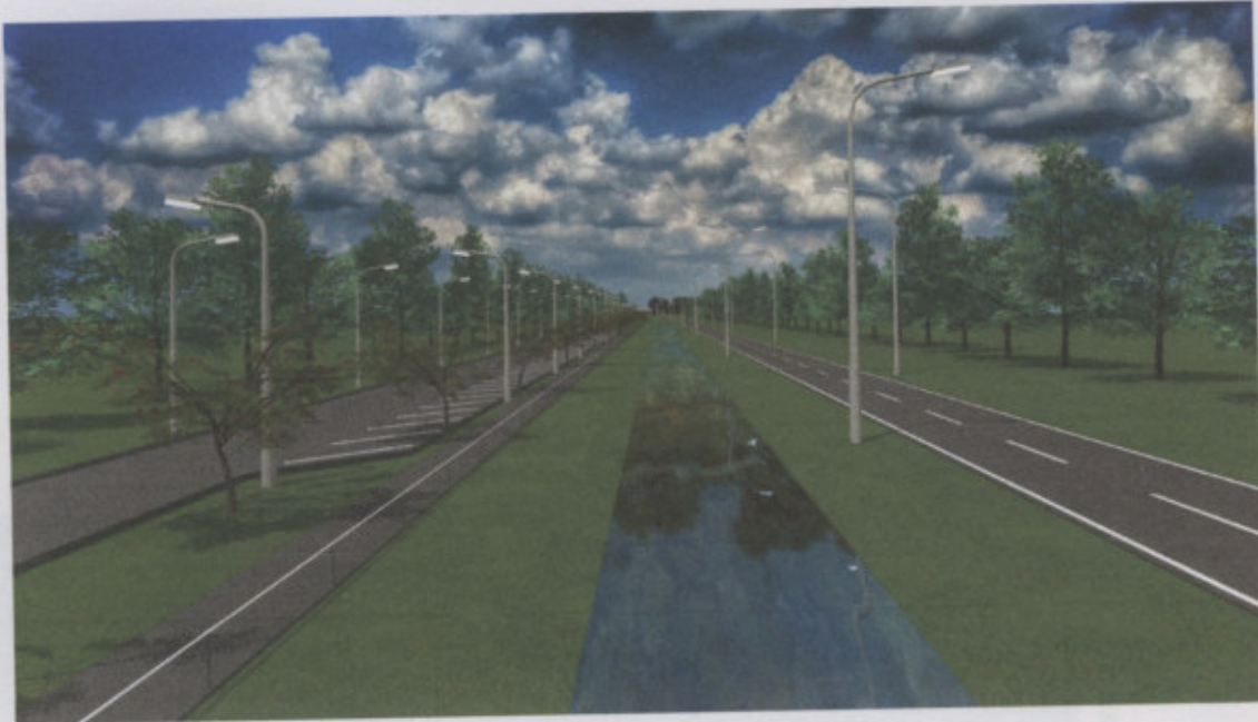
Imagen de la vía paralela Los Ciruelos, senda peatonal y canal a cielo abierto
