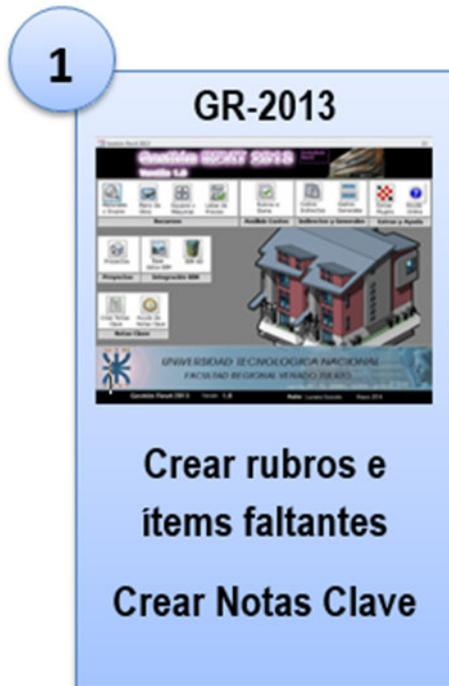
Tenemos un **modelo BIM** construido con **AutoDesk Revit**. El primer paso es repasar el modelo y pensar en todos aquellos rubros e ítems que tendremos que computar y presupuestar. Entonces tendremos que verificar que todos estos componentes del presupuesto estén cargados dentro de GR-2013.
