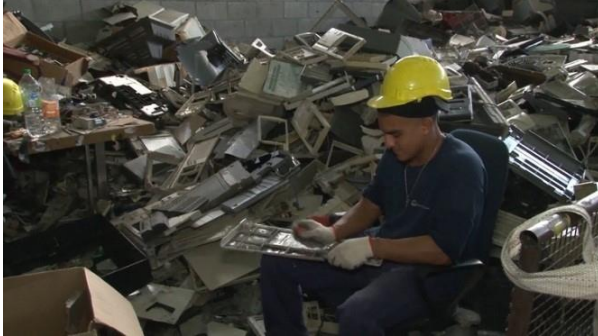
Fotos de Planta: La separación de los componentes RAEE que tiene la basura se hace en forma manual
