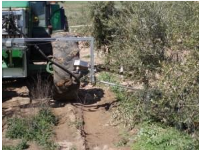
Recortadora de bajas con el palpador delante de la barra de poda.
