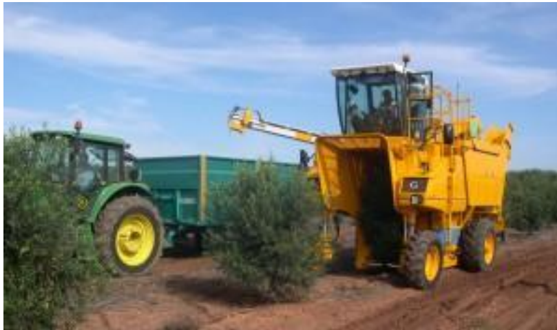
Cosechadora Gregoire G167 con brazo de descarga en el lado derecho y tolva en el izquierdo
