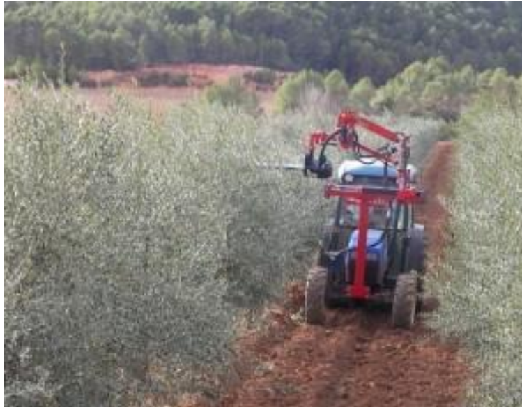
Barra de poda de cuchillas triangulares rebajando la altura de un seto de olivar.
