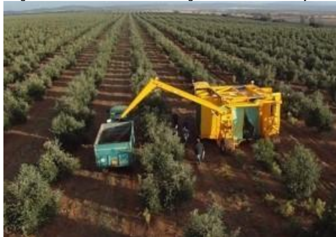
Cosechadora de aceitunas Gregoire G10 apta para trabajar en olivares de porte algo mayor que el superintensivo
