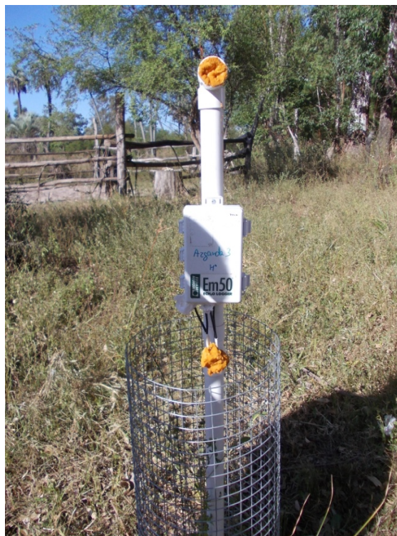
Fig. 3: Estación de monitoreo continuo de temperatura y humedad de suelo instalada en la cuenca del arroyo Palmar.
