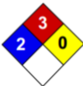
Ilustración 27: Rombo de materiales peligrosos NFPA
