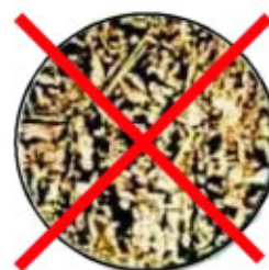
Material de forja con escoria fundida
