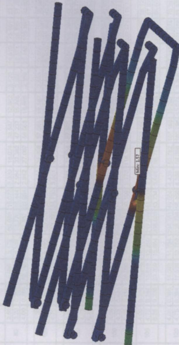
Como podemos apreciar el factor de seguridad es menor a 1, por lo que resulta insuficiente para las condiciones evaluadas, ya que no cumple con el criterio de falla elástica de Tresca-Saint Venant. Por lo tanto, en la próxima simulación tendremos que utilizar un perfil de mayores dimensiones.
