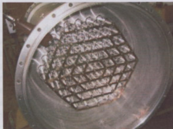
FIG. 1.7 – Generador industrial de ozono para tratamiento de aguas (Spartan Environmental Technologies)
