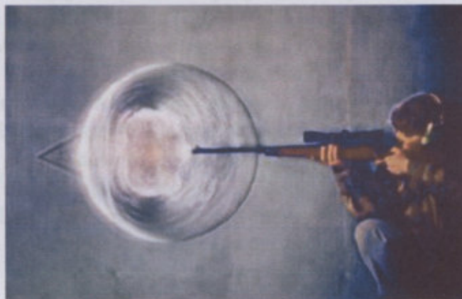
FIG. 1.10– Fotografía Schlieren de una bala supersónica. De Fig. 11 en [1.29]
