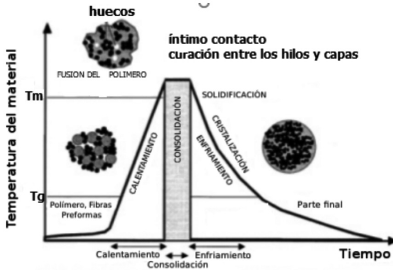
Fig. 18. Evolución del proceso global de soldadura
