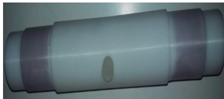
Fig. 27. Vista de tubo con camisa de polietileno soldada – Simulación laboratorio –
