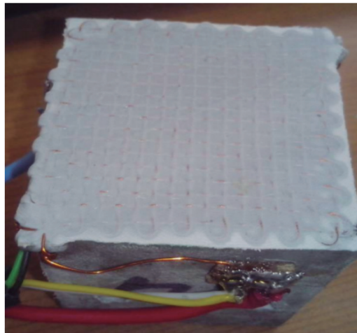
Fig. 11. Vista de la malla embebida insertada en la interfaz de soldadura
