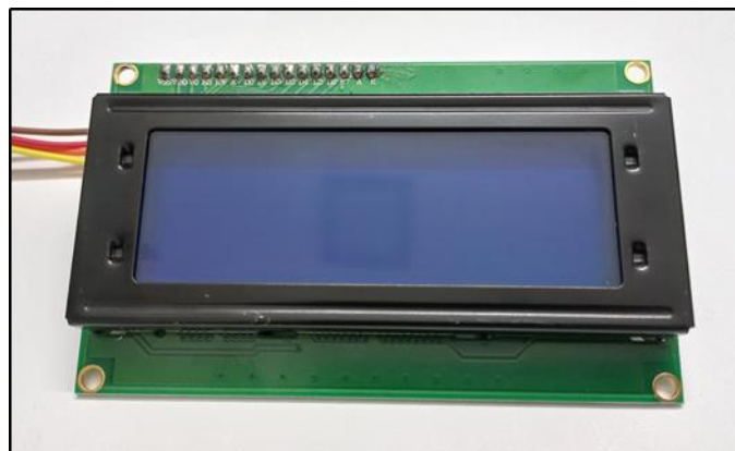
Figura 39: Display LCD 20x4 segmentos.
