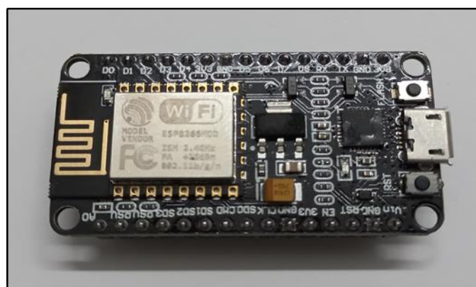
Figura 20: Módulo ESP8266 utilizado.
