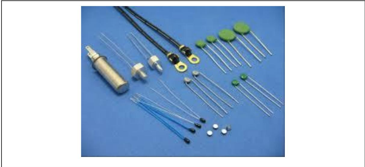
**Figura 2.27** Fotografía de diversos modelos de termistores.
