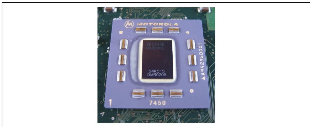
**Figura 2.75** Fotografía de técnica flip-chip.
