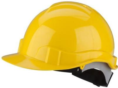
Características: casco de polietileno de alta densidad, arnés interior de polietileno de baja densidad con seis puntos de fijación. Sudadera esponjosa y ajuste manual. Tamaños de cabeza 53/63 cm. Orificios estándar para accesorios. Fijación para barbiquejos con 2 puntos.
