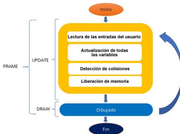
**Figura 2. Ciclo de ejecución de un videojuego.**
