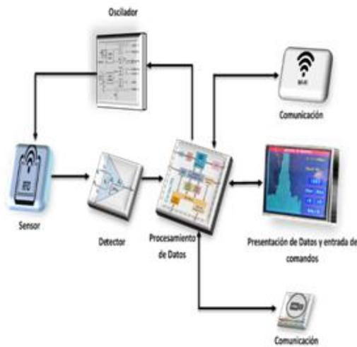
Figura 4: Funcionamiento del lector
