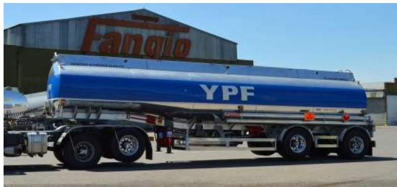
Figura 1 – Modelo de semirremolque cisterna construido por la empresa Tanques Fangio SA, objeto de estudio del presente trabajo.
