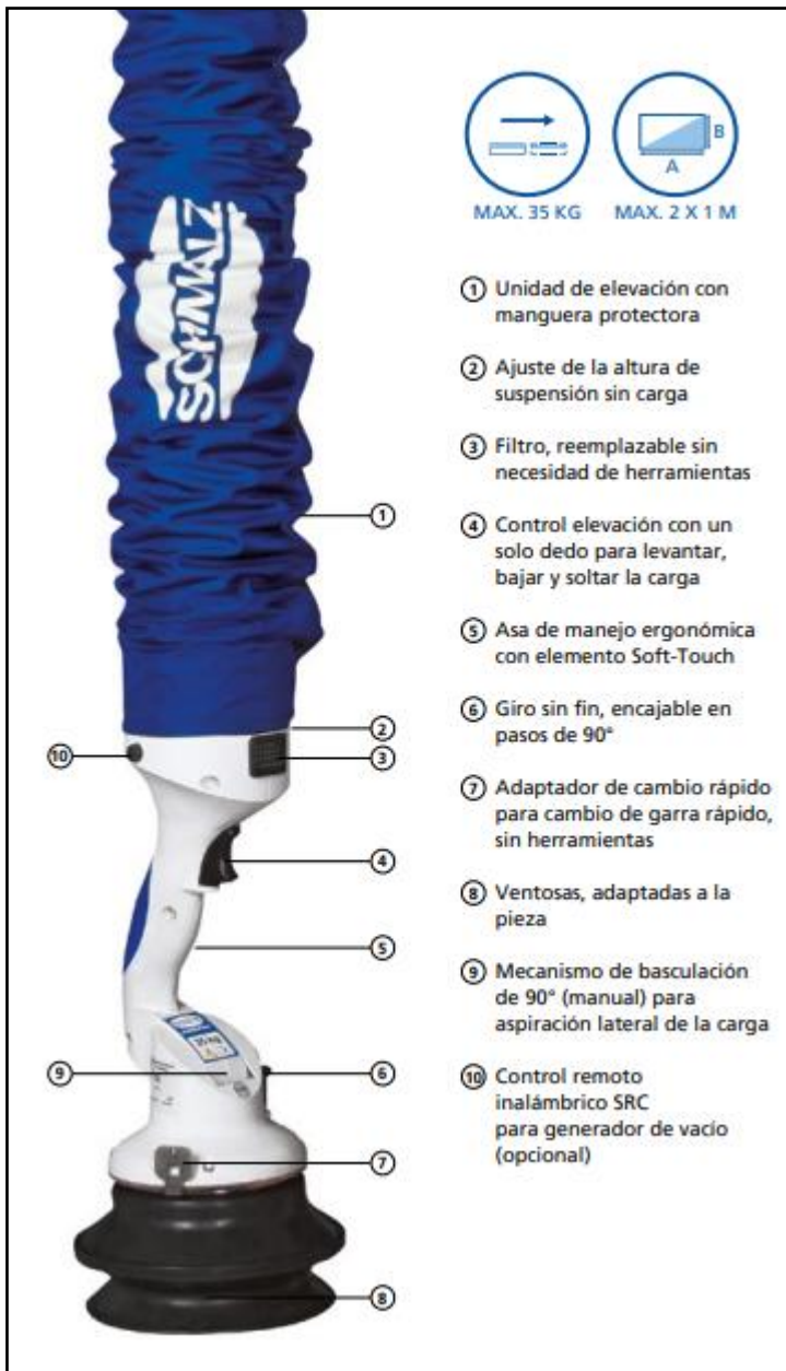
Figura 21. Partes del elevador de vacío JumboFlex.
