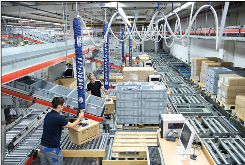
Figura 15. Elevadores de vacío montados en puente grúa. Nota. Adaptado de Tubos elevadores por vacío JumboFlex , por Schmalz en español, 2022, Schmalz ( https://www.schmalz.com/es/equipos-de-elevacion-y-sistemas-de-grua/tubos-elevadores-por-vacio-jumbo/tubos-elevadores-por-vacio-jumboflex/ ). CC BY Schmalz.
