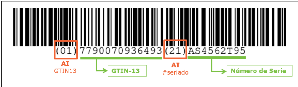
Figura 4. Código de barras GS1 – 128. Nota. Adaptado de Identificadores de Aplicación (p. 5), de Empresa GS1 Argentina, 2022, extraído de Implementación de Estándar GS1.
