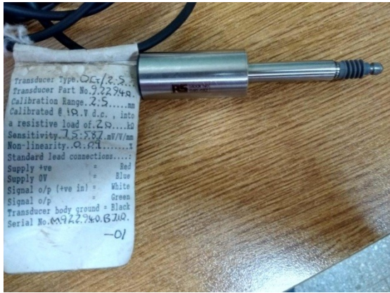
Fig. 5. Uno de los LVDT utilizados en la medición
