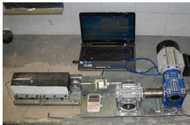
Fig. 1. Equipo para cierre y apertura de fisura
