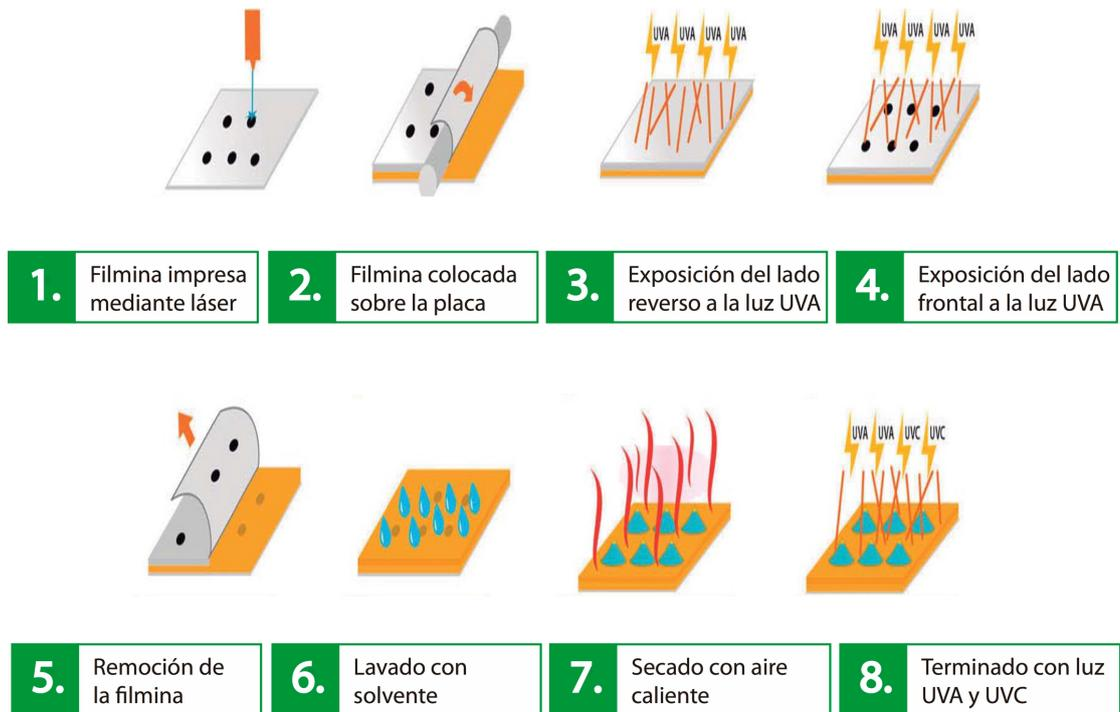
**Figura 2. 1** Método de fabricación del Fmold.
