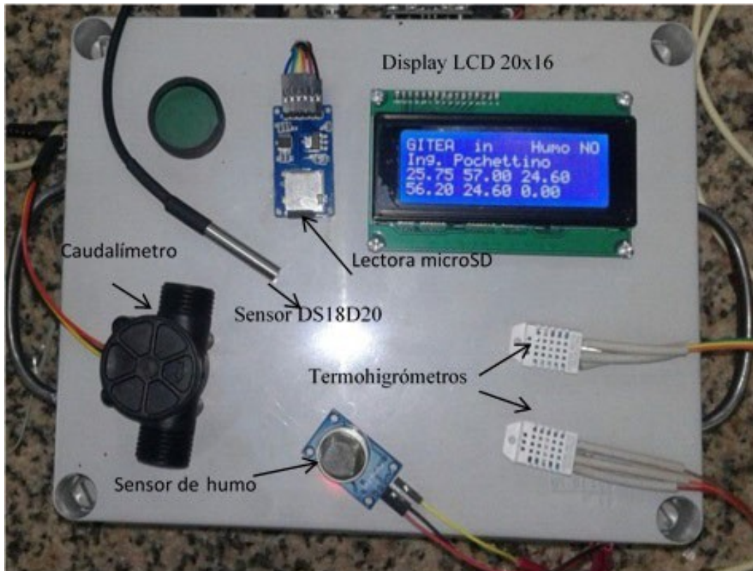
Figura 1.43: Datalogger utilizando Arduino mega 2560
