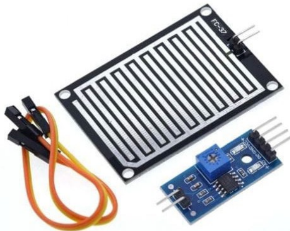
Figura 1.35: Sensor detector de lluvia
