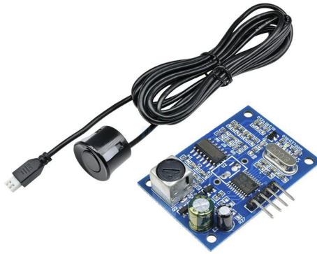
Figura 1.48: Sensor ultrasónico de distancia JSNSr04T.
