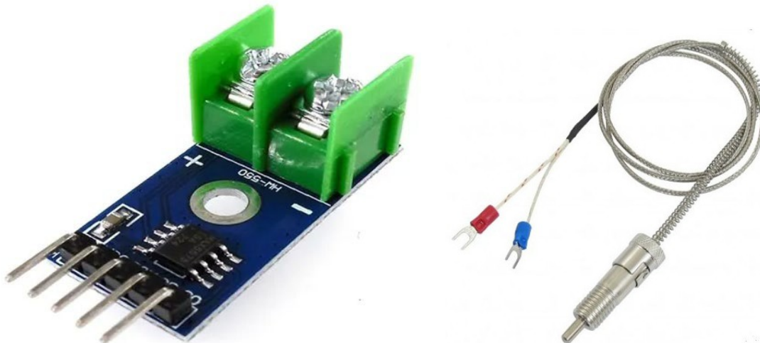
Figura 1.33: Módulo transmisor MAX6675 para termocupla tipo K
