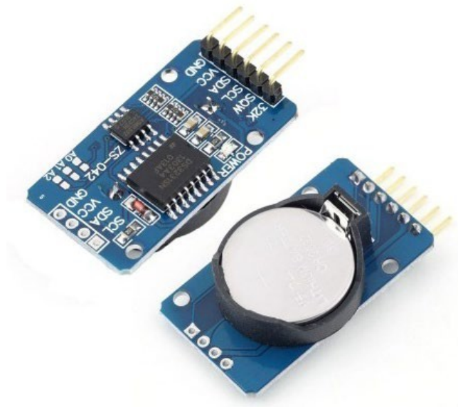
Fig. 1.14: Módulo de reloj en tiempo real o RTC
