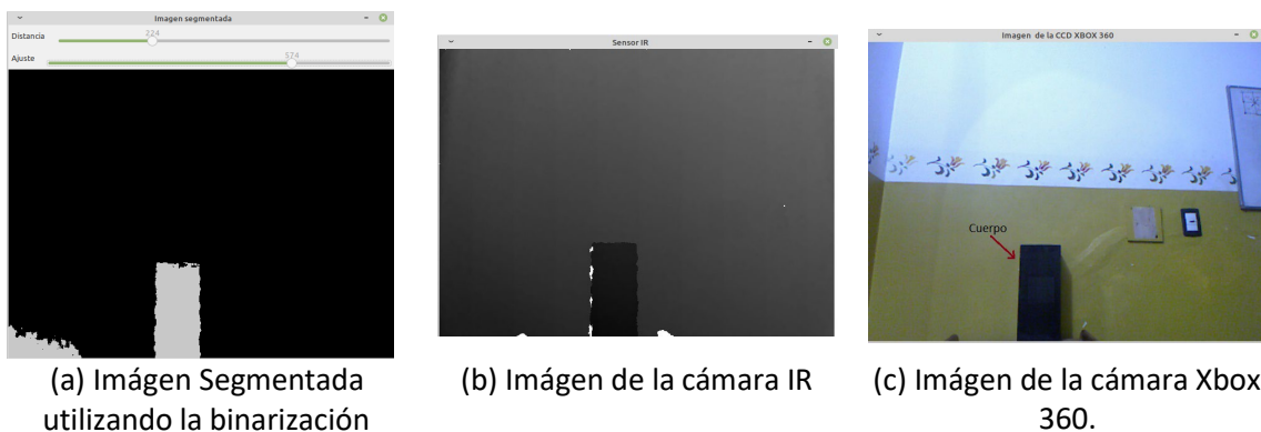
Figura 3.10: Imágenes de la cámara Xbox 360 utilizando python y OpenCV.
