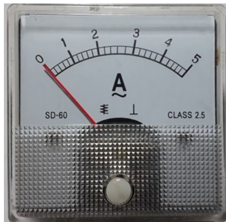
Fig. 1.8: Dispositivo por deflexión utilizada en instrumentos de medida analógicos
