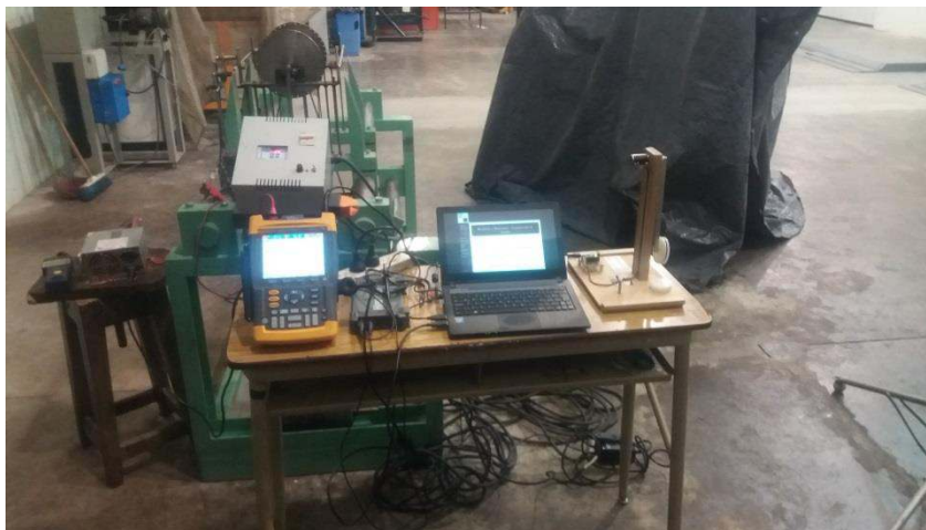
Fig. 2: Análisis de FFT (Fast Fourier Transform) en un equipo educativo de vibraciones.
