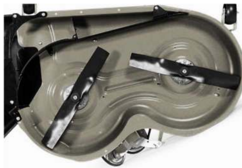
Fig. 4. Plataforma de corte con dos cuchillas vista desde abajo. En orden de marcha las cuchillas giran en un plano paralelo al suelo.
