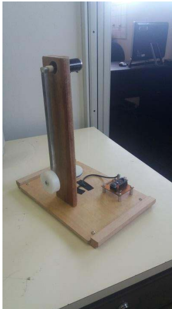
Fig. 3: Sistema péndulo simple con adquisición Arduino Nano.
