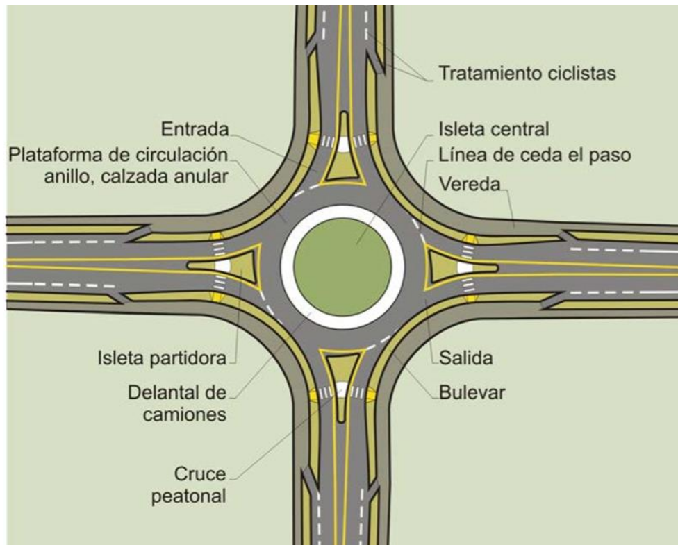
Figura 6-4. Características de la Rotonda Moderna. Fuente: DNV.
