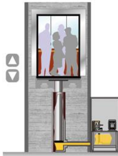
Figura 8-16. Esquema ascensor hidráulico.
