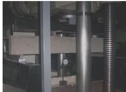
Figura 3. Ensayo a flexión: esquema de ensayo e instrumentación.
