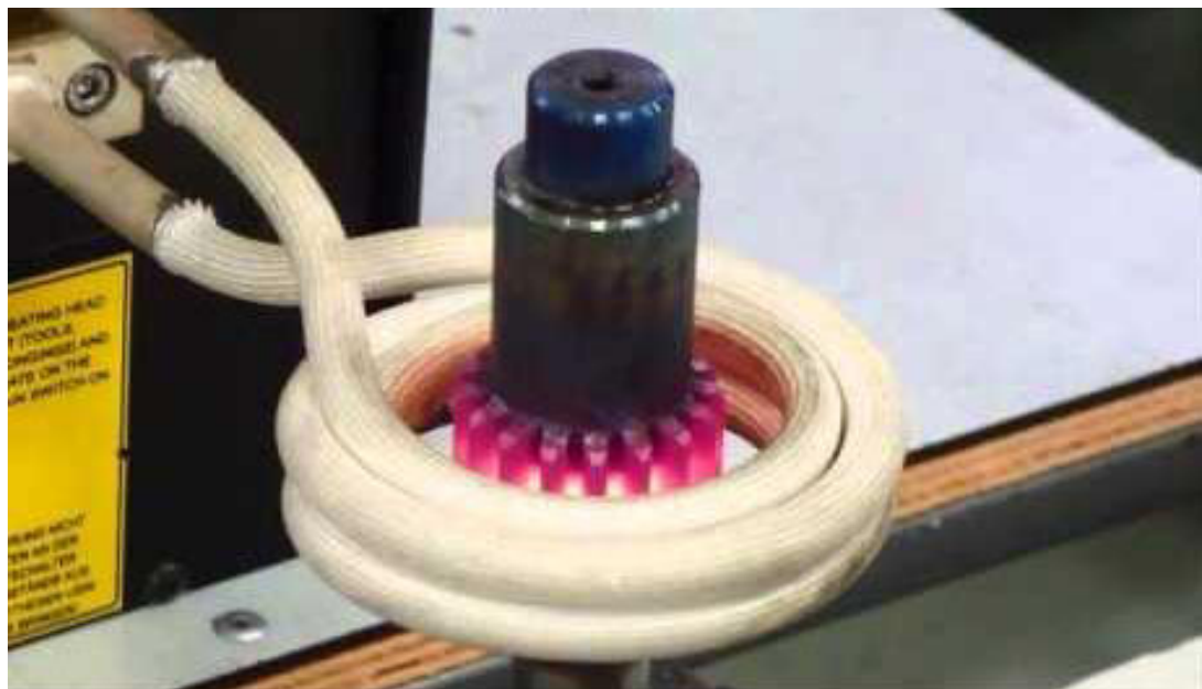
Figura 1.2 – Sistema para tratamiento térmico de engranajes – Fuente: Industrias CEIA
