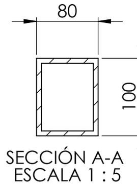
ESPESOR DE PARED: 6,35 mm
