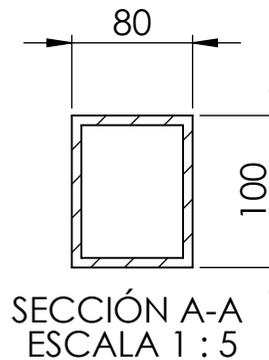
ESPESOR DE PARED: 6,35 mm
