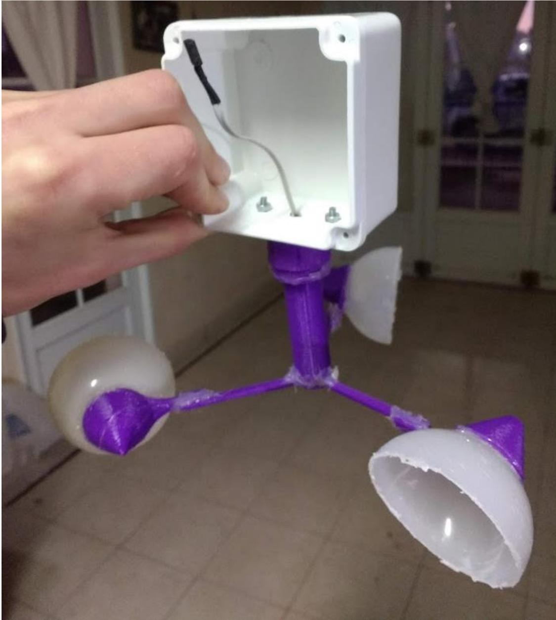
**Fig. N° 45.** Ensamblado del anemómetro en caja estanca.
