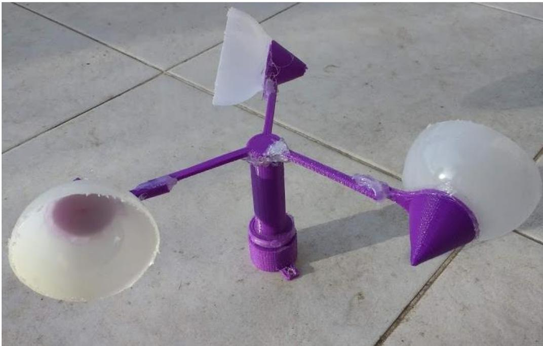
**Fig. N° 39.** *Anemómetro listo para ser colocado en la caja estanca.*
