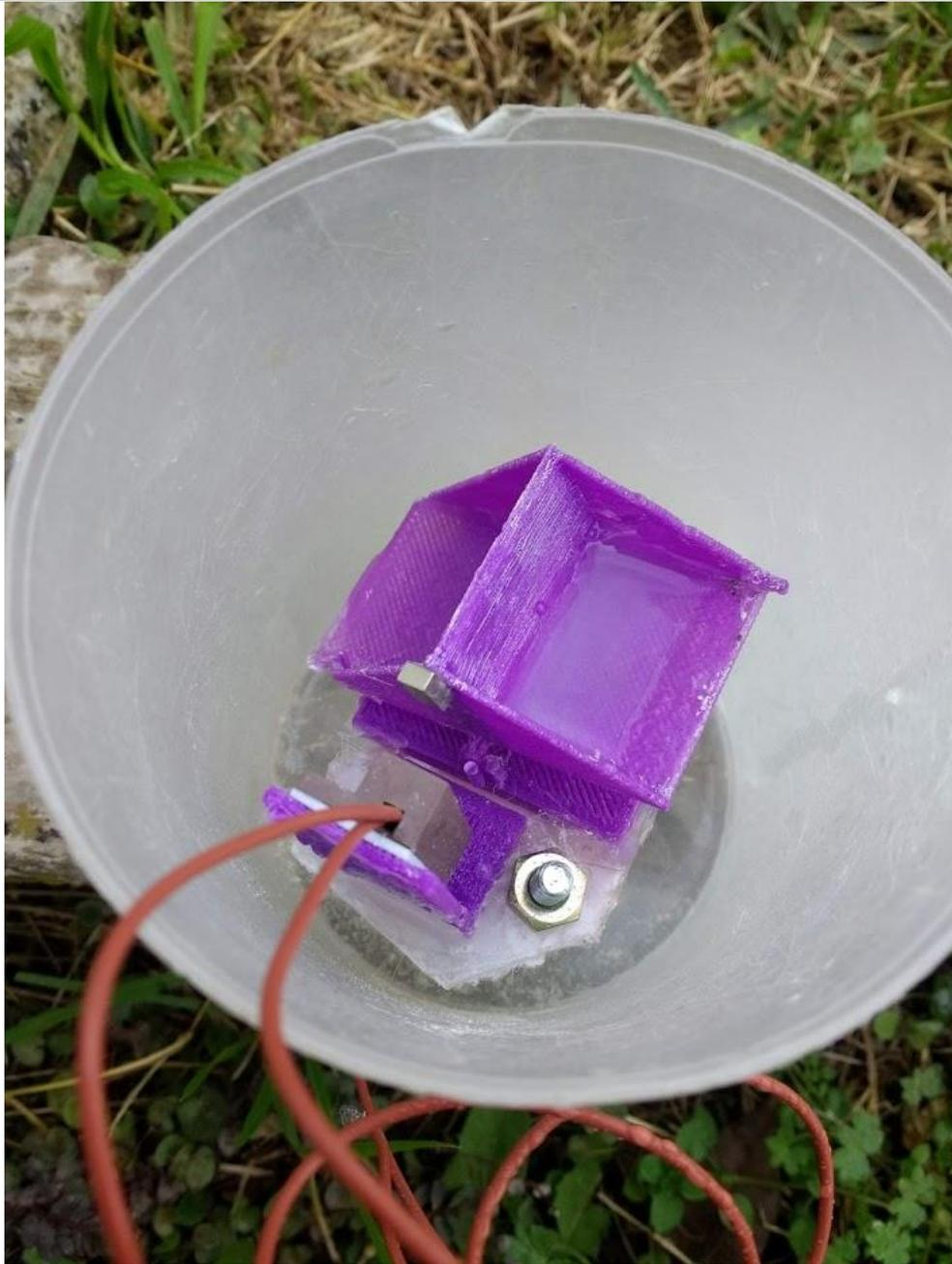
**Fig. N° 43.** Recipiente del pluviómetro con tornillo de montaje.
