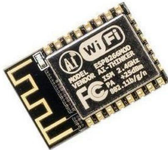
**Fig. N° 2.** Imagen real del módulo ESP-12F.
