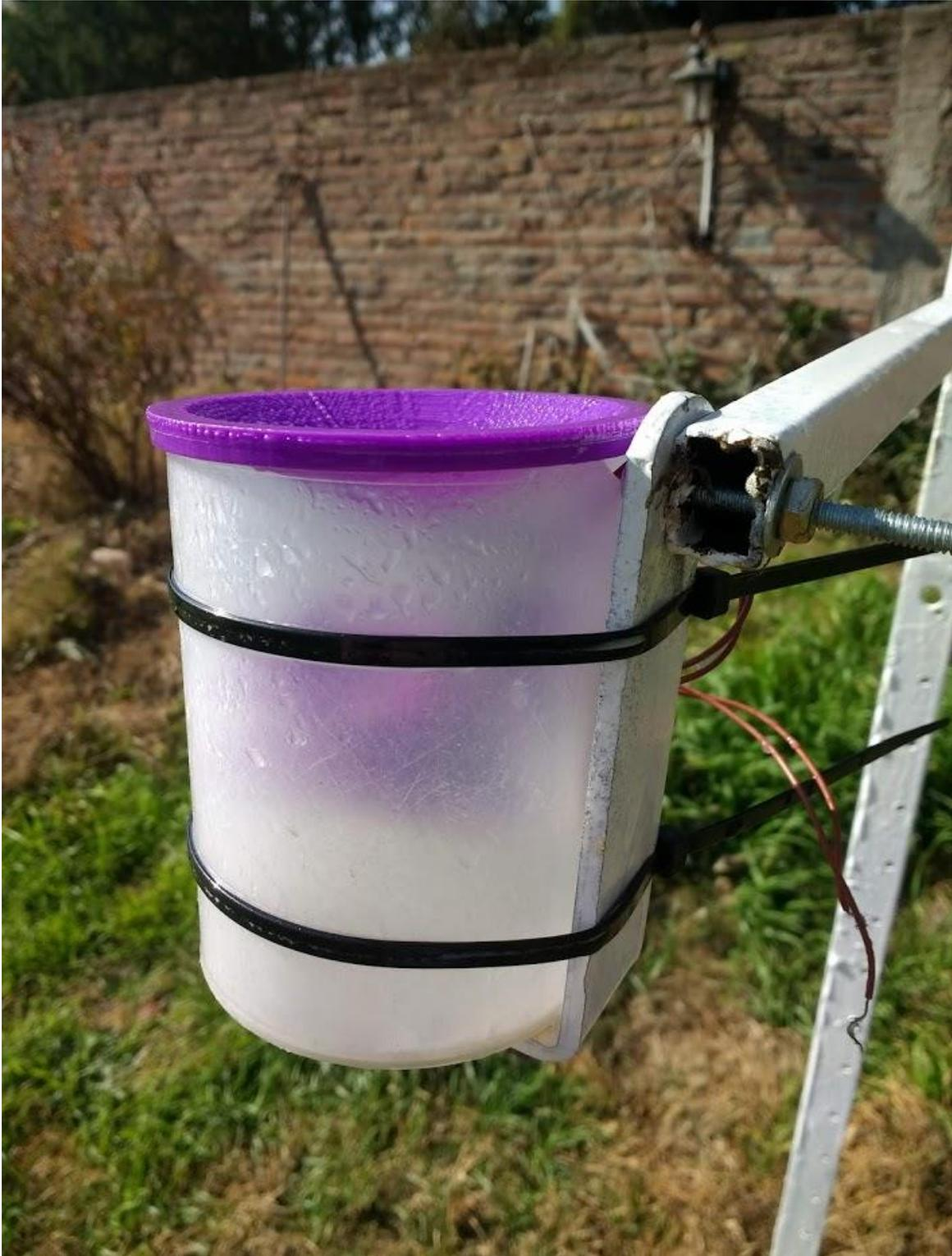
**Fig. N° 55.** *Montaje del pluviómetro a la barra de hierro horizontal.*
