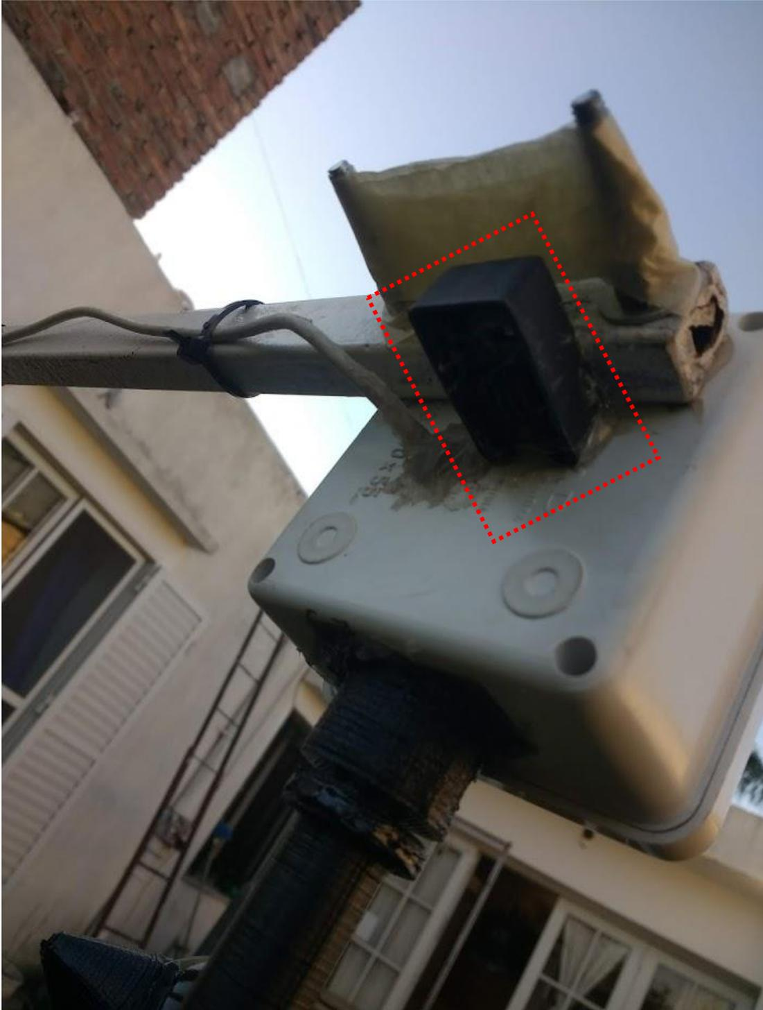
**Fig. N° 57.** Sensor BME280 (en el recuadro rojo) montado y fijado mediante silicona.
