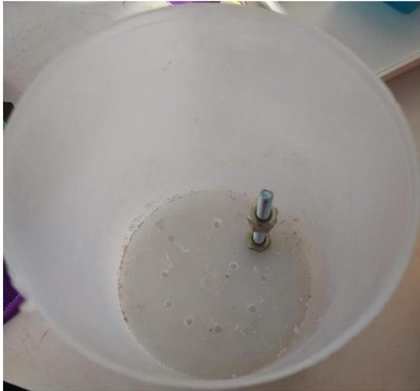
**Fig. N° 42.** Recipiente del pluviómetro con tornillo de montaje.
