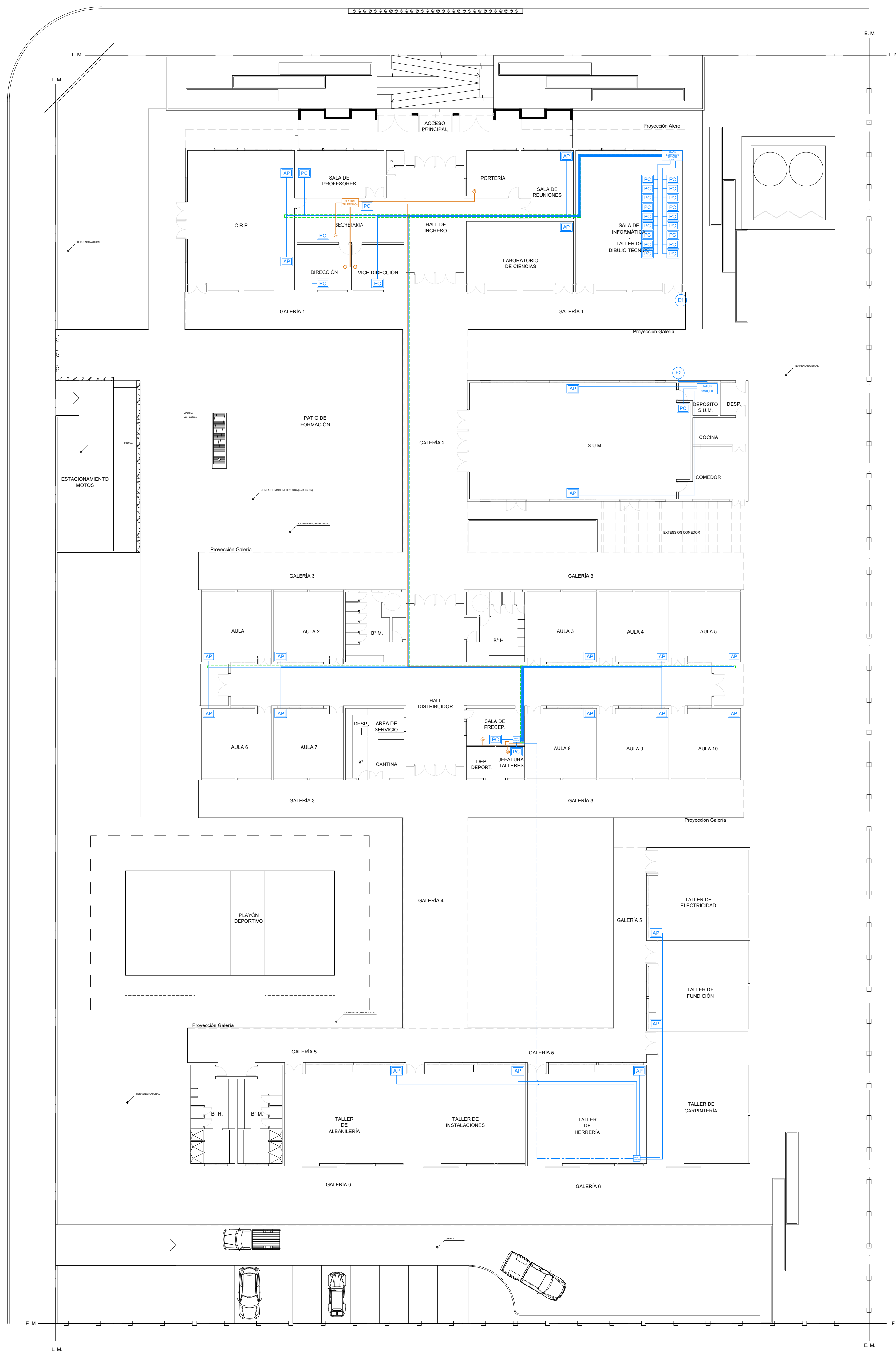
PLANTA DE INSTALACIONES DE CORRIENTES DÉBILES - ESC. 1:200
