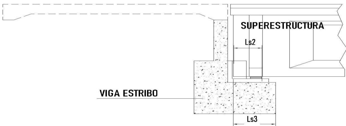
fig.6. Estados Límites según desplazamiento de superestructura
