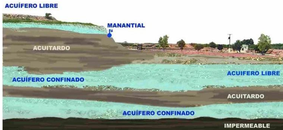
Figura 4. Clasificación de acuíferos según el comportamiento hidrodinámico. (Sistema Integrado de Información del Agua [SIA], 2016).
