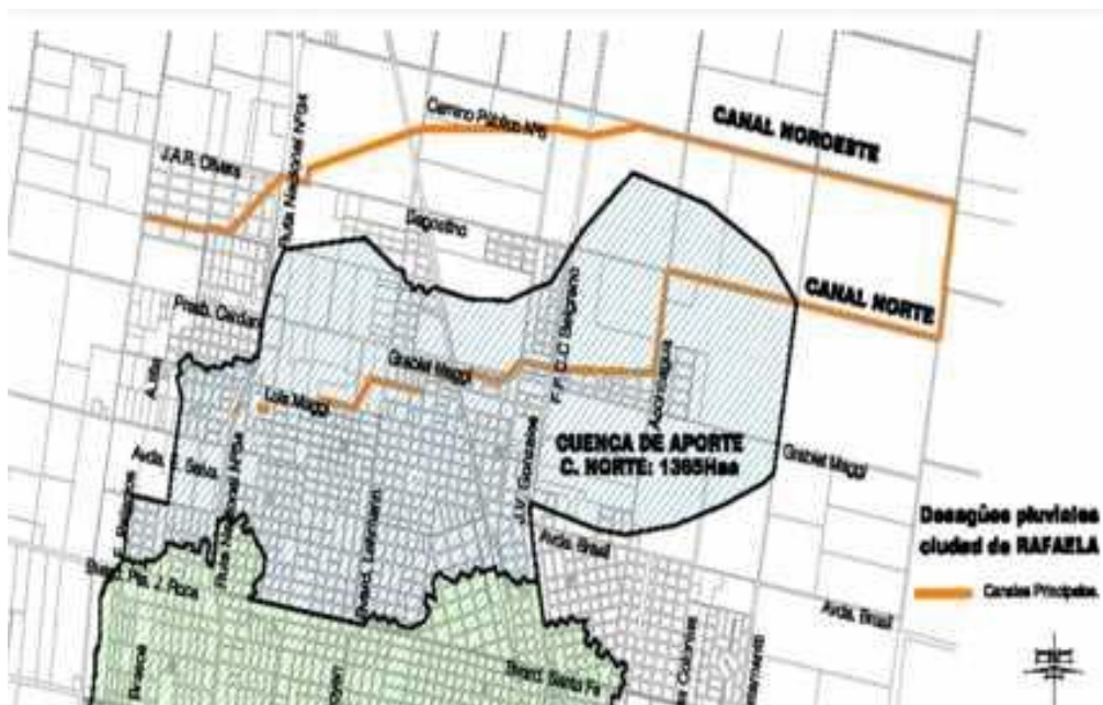
Figura 22. Áreas de aporte Canal Norte Rafaela. Plano en Anexo I. (Ministerio de Infraestructura y Transporte, 2016)
