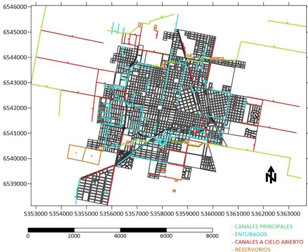
Figura 26. Hidrología urbana de la ciudad de Rafaela, donde se identifican: canales principales, entubados, canales a cielo abierto y reservorios.
