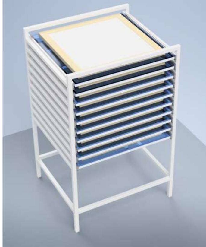
Las estanterías planteadas serán confeccionadas con perfil estructural, un vidrio de 5 [mm] empleado como plano, para lograr un correcto apoyo del molde, y por último correderas telescópicas para vincular los niveles deslizantes a la estructura portante
