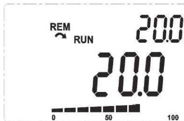
*Figura 14.3: Ejemplo de la HMI en modo monitoreo para la utilización del regulador PID*
