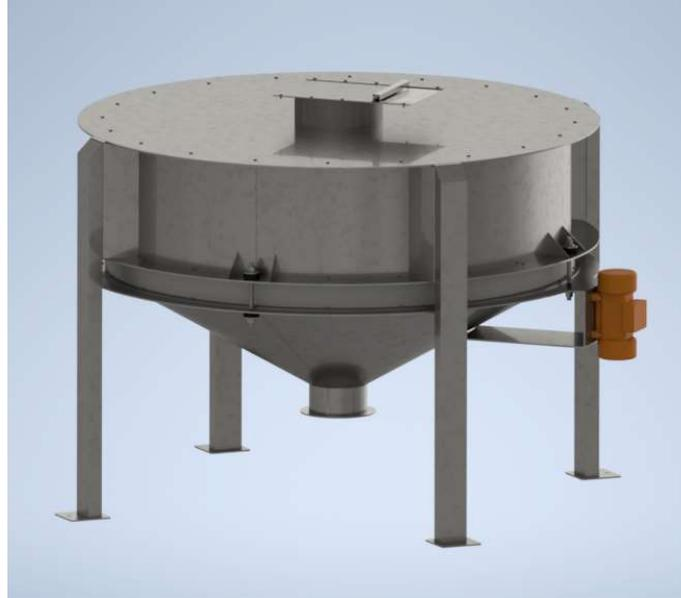
El silo de fondo vibrante será confeccionado en su totalidad por acero, haciendo uso de chapas y perfiles estructurales comerciales. El mismo está compuesto por dos estructuras principales, una de ellas, la superior, que permanecerá de forma fija y opera como silo de contención, mientras en su parte inferior se trata de un fondo vibrante que es agitado por un motovibrador.
