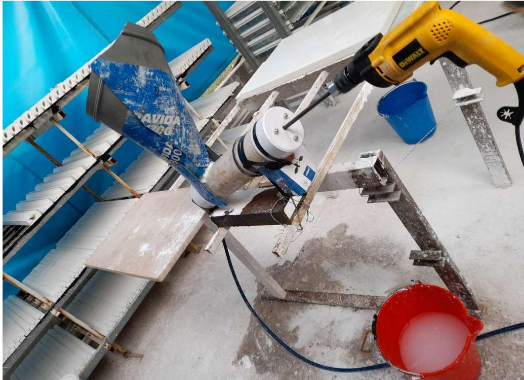
Siguiendo los lineamientos del prototipo, se procede a ejecutar el diseño de un batidor, cuyo tubo mezclador se confeccionará con tubería de 4” en acero inoxidable AISI 304L, y su longitud será de 700 [mm]. Este se dispone con pendiente opuesta al flujo de la mezcla, logrando con ello un mayor tiempo de permanencia entre esta y el batidor, garantizando así la homogeneidad de la pasta.
