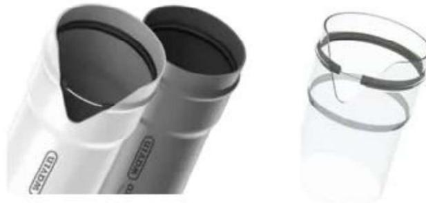
La junta segura garantiza un sello hidráulico muy eficiente, ya que consiste en un aro de caucho sintético forzado internamente con un aro metálico interior que ya viene incorporado desde fábrica en el enchufe del caño, formando así una sola pieza. Éste sistema evita que cuando la cañería esté en funcionamiento no se produzcan corrimientos del aro de caucho, lo cual garantiza que no existan pérdidas de líquidos en el sistema de unión espiga-enchufe.
