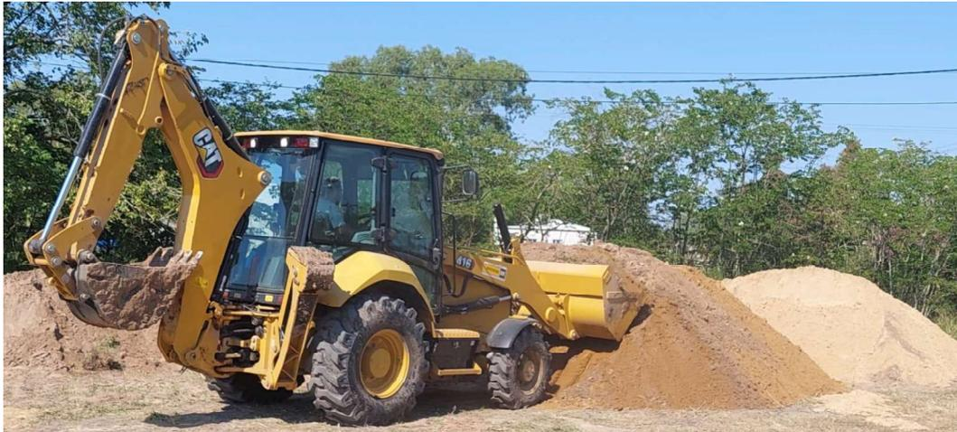
Al igual que para excavación, se deberá extraer del manual de Caterpillar la capacidad del cucharón. Para el de uso general posee una capacidad de **0,76 m<sup>3</sup>**
