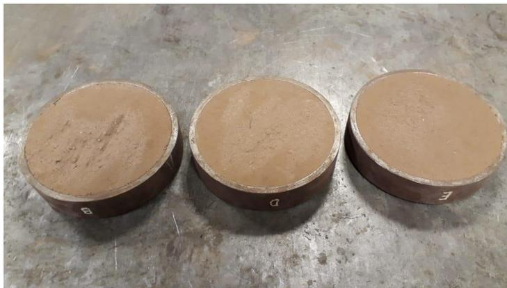
**Figura 8.** Probetas luego del ensayo, de izq. a der.: “A”, “A+DO” y “A+DO x2”. Fuente: elaboración propia
