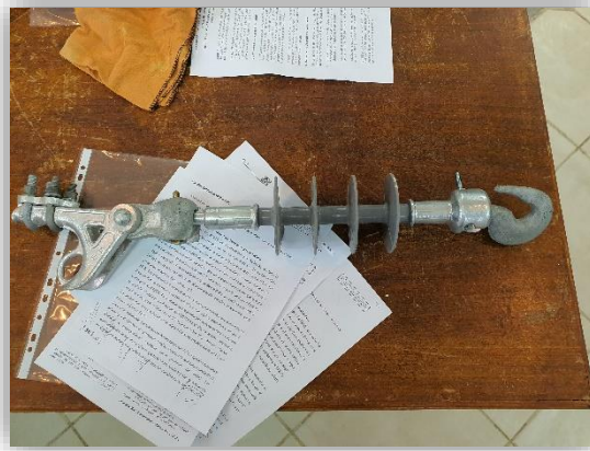
(Cadena de Retención conformada por Morsa de Retención MR14, Órbita MN154, Aislador orgánico RL4 y Gancho MN173)
