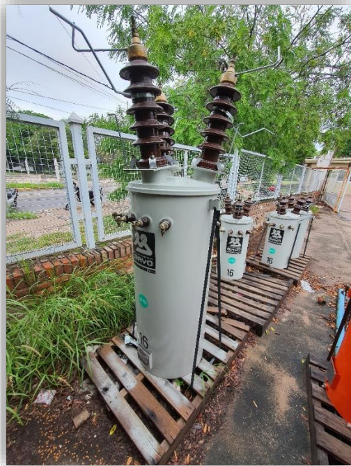
(Transformador Trifásico 13,2/0.4-0,231 Kv – 16 kVA con su respectiva placa de datos técnicos)
