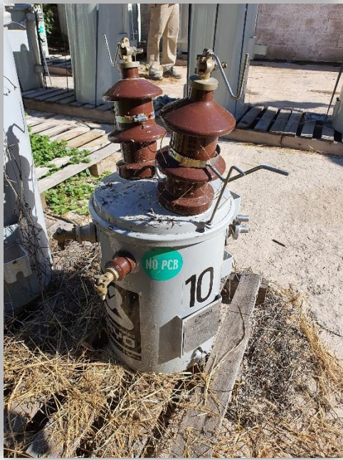
(Transformador Monofásico de 10 kVA; 13,2/0,231 kV con su respectiva placa de características)
