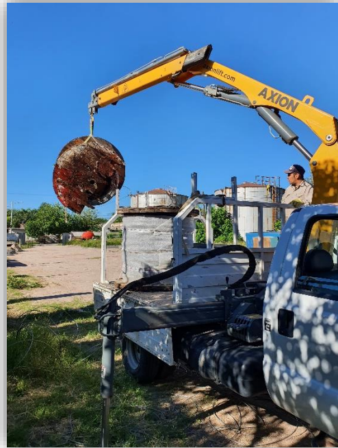
(Carga de bobina con conductor de aluminio desnudo de 25mm 2 a la empresa contratista)
