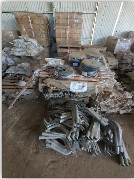
(Brazos metálicos para alumbrado público, rollos de cables TPR 2x2,5mm 2 , jabalinas de cobre 5/8" x 1500 mm, tillas con ojal MN514 y atrás se observan cajas con aisladores MN3)
