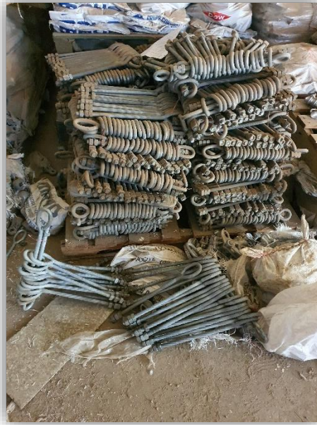
(Tillas con ojal MN514 empleadas para la sujeción de las cadenas de retención a las crucetas de madera)
