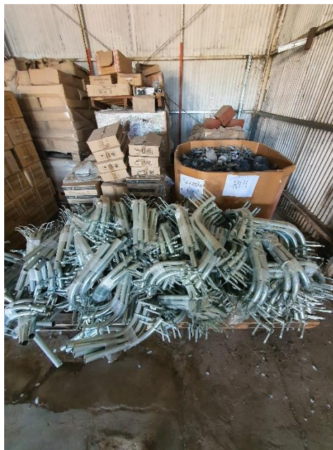
(Brazos metálicos para alumbrado público; atrás se visualizan un cajón con aisladores poliméricos RL4, cajas con descargadores de 12kV – 10kA y muertos de madera)
