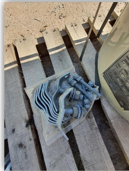
(Bulones y abrazaderas para la fijación del transformador al poste de madera)
