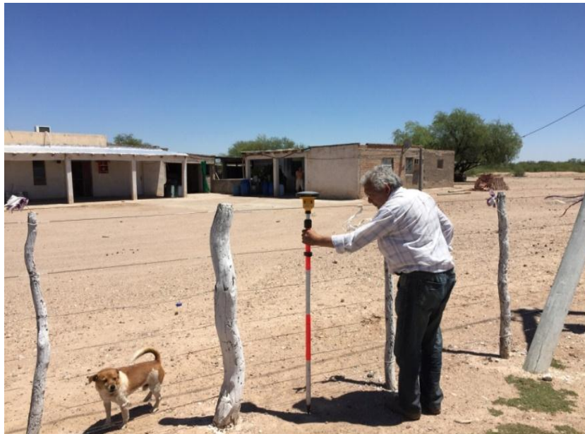
Figura 1: Relevamiento con GPS geodésico
