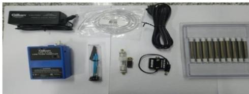
Figura 5. Equipo de muestreo de aire para análisis por desorción térmica.
