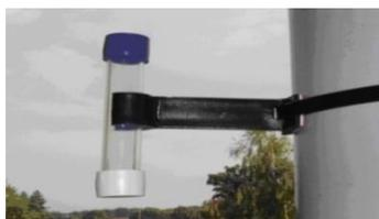
Figura 2. Tubo de muestreo de aire pasivo.
