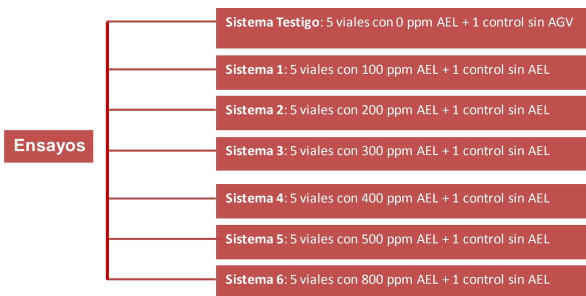
**Figura 9.** Esquema de los ensayos utilizados para determinar el efecto inhibitor del AEL.
